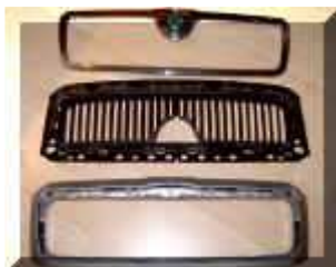
Der Grill ist nun in seine drei Bestandteile zerlegt.
