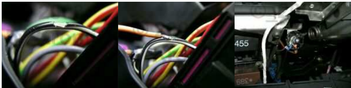
(5) + (6) Kabel zum Anlöten freigelegt - (7) Massestern unterhalb des Lenkstocks
