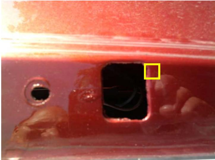
Das ist auf beiden Seiten durchzuführen und anschließend mit Hamarite oder gleichwertigen gegen Rostbildung zu behandeln.
