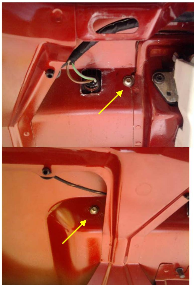
Anschließend die beiden Fassungen der alten Kennzeichenbeleuchtung aus der Griffleiste herausziehen. Dann kann man die Griffleiste vorsichtig abnehmen.
