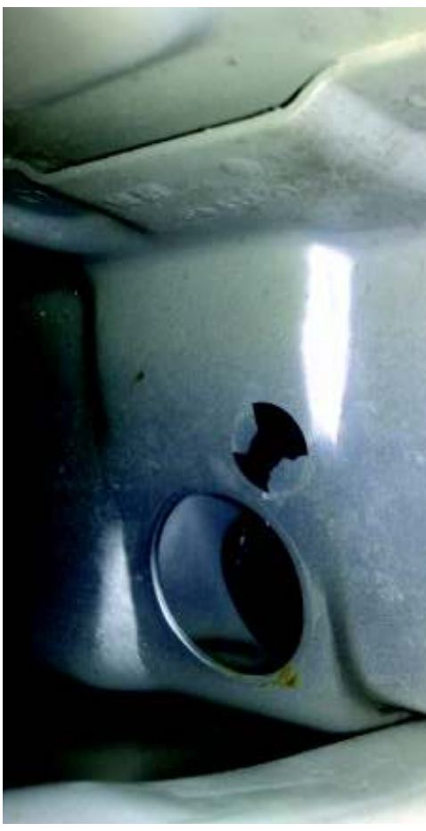
Türkabelbaumdurchführung innerhalb der Tür (pink markiert)
