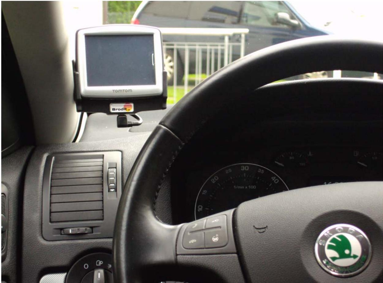
Für die Grundbefestigung des Navi habe ich die Halter des US Herstellers RAM Mount verwendet, sowie die Brodit Halterung mit integrierter Spannungsversorgung.
