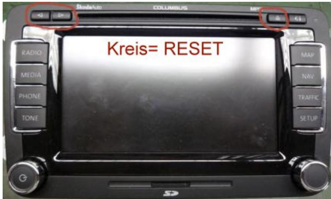
RESET: Man Betätigt die 2 Tasten Links und die 1 Taste Rechts gleichzeitig siehe Bild.
