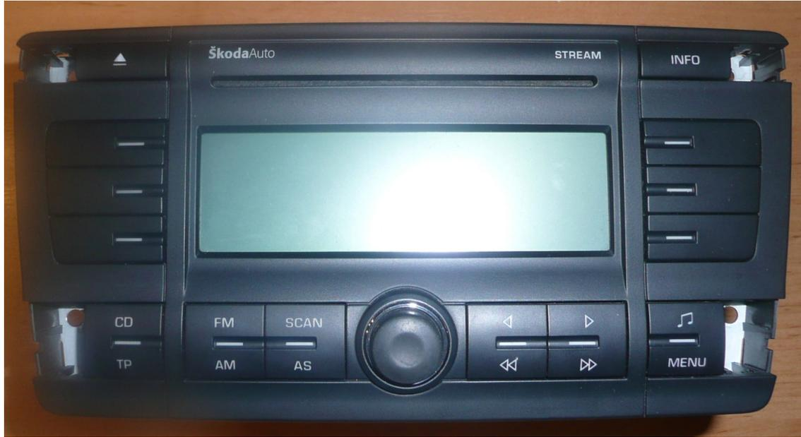
Der Ausbau ist eigentlich nicht schwer! Man muss nur die 4 Blindkappen entfernen und die dahinter sitzenden Torx schrauben lösen.
