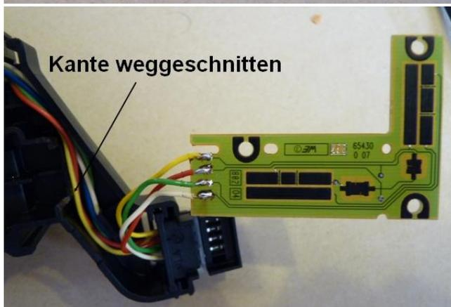
Da die Kabel sehr kurz sind, muss man den Stecker vorsichtig zerlegen und die Kabel aus den "Schwalbenschwänzen" der Kontakte ziehen. Wenn es dann immer noch zu kurz ist, kann man die markierte Kante mit einem Cuttermesser wegschneiden. Dann sind die Kabel lang genug.
